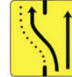
TS-61 DESVÍO DE UN CARRIL POR LA CALZADA OPUESTA, MANTIENIENDO OTRO POR LA DE OBRAS
